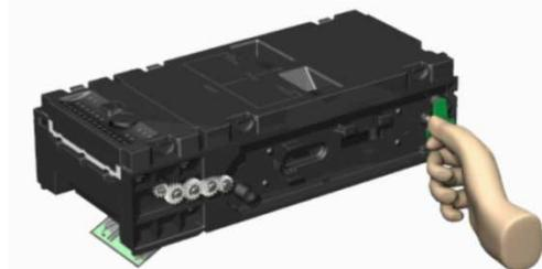
Figure 13: Extraction de billets au moyen de la clé verte.
